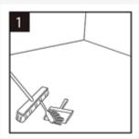
Der Unterbau muss eben, trocken und sauber sein. Teppichklammern oder Klebstoffreste müssen entfernt werden und der Boden muss sauber sein, um eine ordnungsgemäße Verlegung zu gewährleisten.
