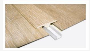
Bei Oberflächen von mehr als 400 m2, mit einer Länge von mehr als 20 m oder mit Übergängen von Click&Floor zu anderen Materialien, empfehlen wir die Nutzung von T-Profilen mit einer Dehnungsfuge (wie die Umgebungsfuge).
