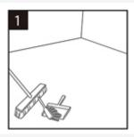
Der Unterbau muss eben, trocken und sauber sein. Teppichklammern oder Klebstoffreste müssen entfernt werden und der Boden muss sauber sein, um eine ordnungsgemäße Verlegung zu gewährleisten.
