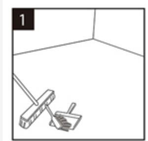
Le sous-plancher doit être de niveau, sec et propre. Les agrafes de tapis ou les résidus de colle doivent être enlevés et le plancher doit être propre pour assurer une installation appropriée.
