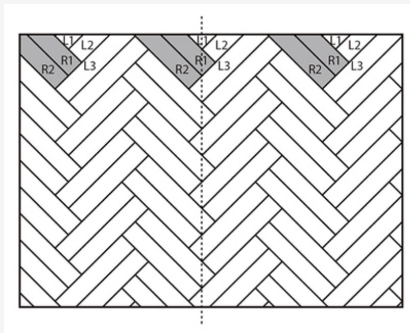
– Utilisez le modèle de coupe à l'intérieur de la boîte pour dessiner l'ensemble initial de 5 pièces du double Chevron (L1, L2, L3, R1, R2). Nous vous suggérons d'utiliser un crayon rouge pour faire un modèle selon le tableau suivant.
