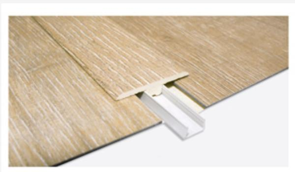
Per superfici superiori a 400 m<sup>2</sup>, lunghezze superiori a 20 m o per la transizione da Click&Floor ad un altro materiale, si raccomanda l'uso di profili a T, rispettando il giunto di dilatazione (uguale al giunto perimetrale).
