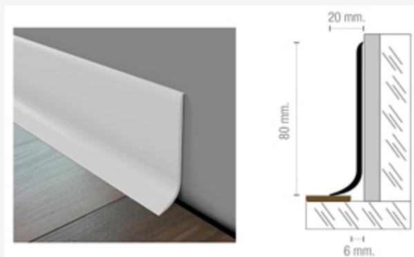
Flexi è un battiscopa in PVC semiflessibile che unisce le eccellenti proprietà di resistenza del PVC rigido con il grado di flessibilità ideale per adattarsi a pareti irregolari o leggermente curve. La sua rifinitura "scozia" agevola la pulizia, evitando l'accumulo di germi. Molto adatto per coprire i giunti perimetrali. Facile da installare, si colloca incollato alla parete e si appoggia sul C&F senza bloccarlo. È perfetto per ristrutturazioni e nuove costruzioni.
