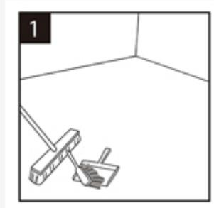
El subsuelo debe estar nivelado, seco y limpio. Las grapas de moquetas o residuos de pegamento deben ser eliminados y el piso debe estar limpio para asegurar una instalación adecuada.
