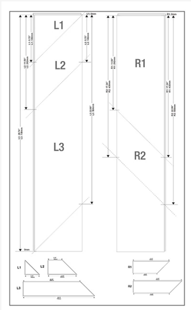
Cuando llegue a ambos lados de las paredes, mida la distancia entre la pared y el set inicial más cercano. Arme un nuevo set, marque la distancia medida en él, corte los tablones (para esto puede desarmar el set) e instale los tablones en el hueco restante.
