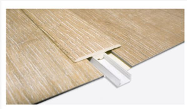
Para superficies que excedan de 400 m<sup>2</sup>, longitudes superiores a 20 m o para transición de Click&Floor a otro material, se recomienda la utilización de perfiles en T respetando la junta de dilatación (misma que la perimetral).
