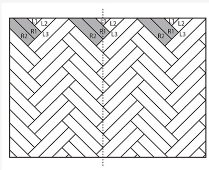
– Utilice la plantilla de corte en el interior de la caja para dibujar el set inicial de 5 piezas del Chevron doble (L1, L2, L3, R1, R2).
